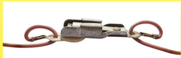
Limitatore di temperatura per coperte Calor a rottura lenta, calibrato a 80°C (1960 circa). Si noti la guaina impermeabile in PVC saldata sui fili e l'anello formato dai conduttori elettrici che passano attraverso un foro in ogni terminale, per eliminare le tensioni di trazione sui fili (Ultimheat Collection).
