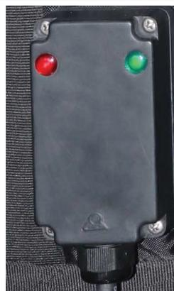
Termostato ambiente meccanico a temperatura fissa incorporato nel coperchio della scatola di connessione. Attivazione automatica del riscaldamento quando la temperatura scende sotto i 5°C, con luci pilota che indicano l'accensione e l'attivazione del riscaldamento.
