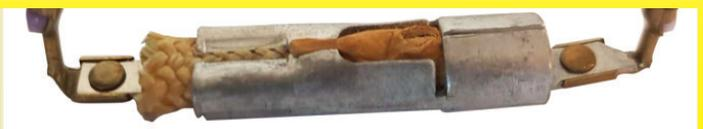
Limitatore di temperatura della coperta di riscaldamento a rottura lenta, utilizzato in combinazione con un sistema di controllo della potenza inglese prodotto da GEC (General Electric Company). È coperto da una guaina impermeabile in PVC, saldata ai fili. Intorno al 1970 (Ultimheat Collection)
