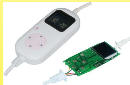
2019 Unità di controllo per coperte riscaldanti termoregolate con display digitale tramite sonda a termistore incorporata nella zona riscaldata (Ultimheat Collection).
