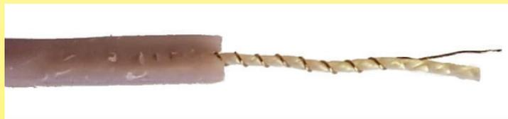
Filo scaldante flessibile, isolato in PVC, di diametro molto piccolo (2 mm), conduttore singolo di diametro 0.11 mm in lega di rame (probabilmente alpacca), avvolto su un'anima di poliestere di diametro 0.5 mm, utilizzato su una coperta riscaldante General Electric (Inghilterra), intorno al 1962. L'unità è molto combustibile. (Ultimheat Collection)
