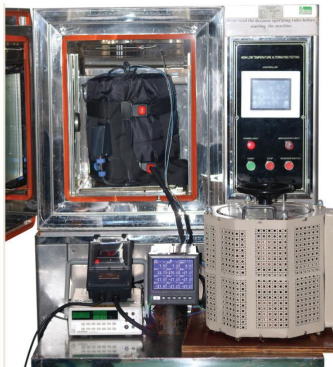
Riscaldatori per mantelli durante i test climatici a temperature negative
