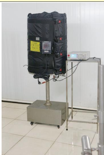
Misurazione della resistenza di isolamento dopo i test IPx6
