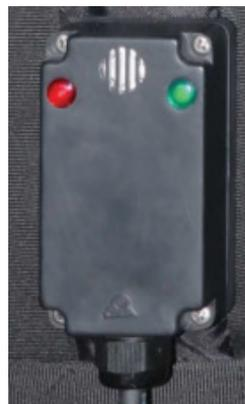
Termostato elettronico per sensore NTC. Azione On-Off con anticipazione, regolazione tramite manopola, con luci pilota che indicano l'accensione e il riscaldamento.
