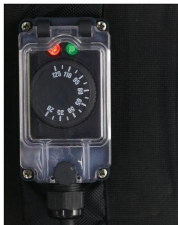
Termostato elettronico per sensore NTC. Azione On-Off con anticipazione, display digitale. Montaggio diretto sul connettore del riscaldatore della coperta o del mantello. Controllo della temperatura in base alla temperatura della parete del contenitore.
