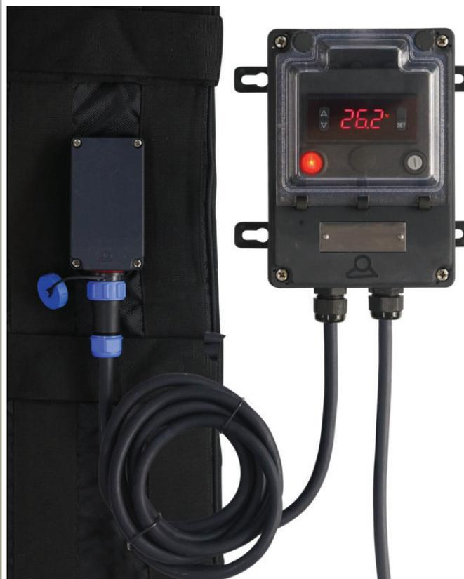
Termostato elettronico per sensore NTC. Azione On-Off, display digitale. Montaggio a parete remoto. Caratterizzato da una lunga sonda di rilevamento della temperatura da immergere nel liquido. Può essere utilizzato in aggiunta al controllo della temperatura superficiale, per terminare il processo di riscaldamento quando viene raggiunta la temperatura centrale del liquido.
