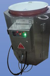
Forni avvolgenti rigidi, per il riscaldamento rapido di fusti a infrarossi
