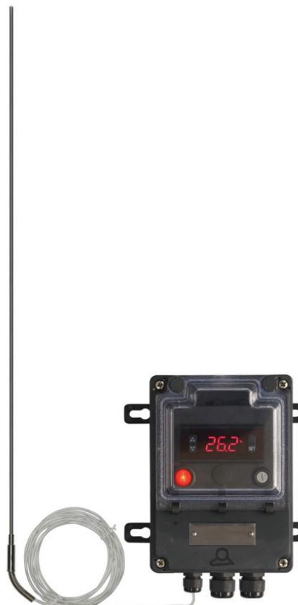
Controller elettronico di temperatura, ingresso sensore Pt100, azione PID auto-tune. Doppio display digitale: temperatura misurata e valore di set-point. Controllo della temperatura in base alla temperatura della parete del contenitore. Disponibile solo con scatola di controllo remoto. **Questa versione, che utilizza un sensore di tipo Pt100, non è intercambiabile con i modelli di riscaldatori di coperte e mantelli con sensore NTC incorporato.**
